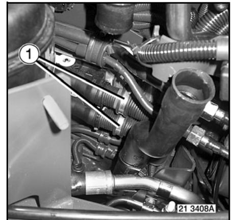
Tirer les verrous (1) et débrancher les connecteurs (2).
