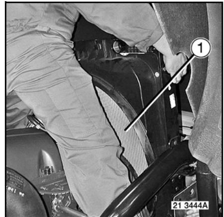
Si nécessaire, replacer correctement le joint de la buse du radiateur (1).
