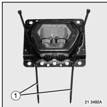
Positionner le plot de suspension (1) dans le châssis.
