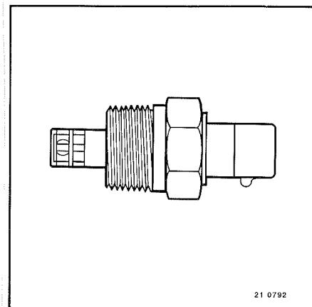
**Датчик температуры жидкости охлаждения (7362)**
