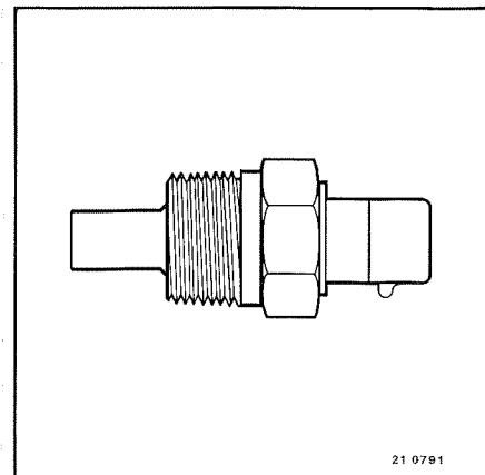
**Датчик положения зубчатой рейки топливного насоса (9265) (1)**
