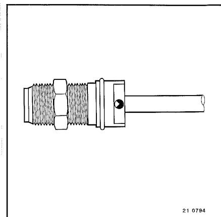
**Датчик режима топливного насоса (9262)**
