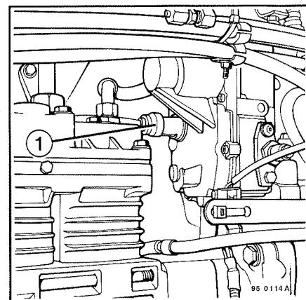
**Клапан топливоподкачивающего насоса (1)**
