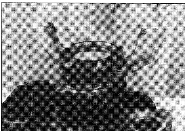
16. Снять 4 винта с шестигранной головкой, придерживающих уплотнительную базу и картер подшипника качения выходного вала. Снять уплотнительную базу.
